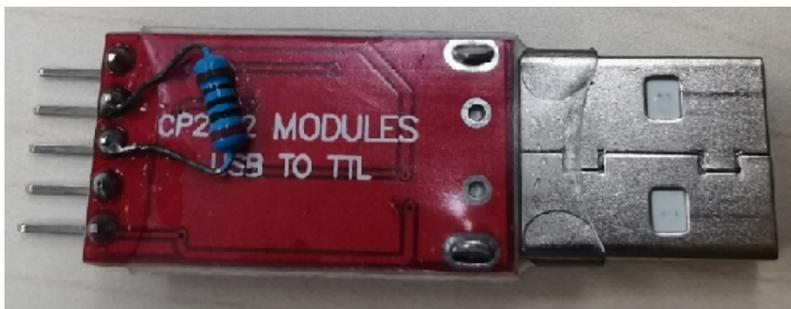
2、串口模块的（GND,RX,3.3V）3 根线接到开发板（GND,PB3,3.3V）上，另一端接电脑的 USB 口。
